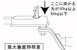
仮に最大垂直静荷重が45kgとした場合、実際に車が走行すると45kg×2.5倍=112.5kg位の力が車の最後部に掛かる計算になります。ヒッチメンバーの許容範囲はもちろんカブラーに掛かる垂直荷重の方が十分に注意が必要です。
