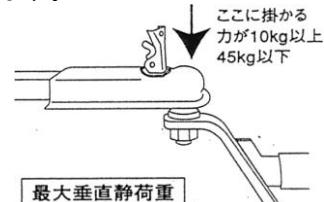
最近の衝撃吸収ボディーや燃費向上を図った軽量化のため、特にモノコックボディー車は車側の取付部分が弱く、破損する恐れがあります。
