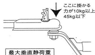
最近の衝撃吸収ボディや燃費向上を図った軽量化のため、特にモノコックボディ車は車側の取付部分が弱く、破損する恐れがあります。
