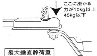
最近の衝撃吸収ボディー や燃費向上を図った軽量化のため、特にモノコックボディー車は車側の取付部分が弱く、破損する恐れがあります。
