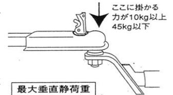
最近の衝撃吸収ボディや燃費向上を図った軽量化のため、特にモノコックボディ車は車側の取付部分が弱く、破損する恐れがあります。
