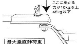
最近の衝撃吸収ボディーや燃費向上を図った軽量化のため、特にモノコックボディー車は車側の取付部分が弱く、破損する恐れがあります。
