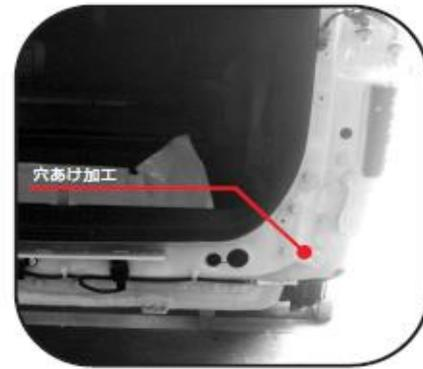
※左写真は車両右側のおおよその穴位置です。横・下方向から必ず確認しながら印をしてください。6mm程度のドリルで穴を開け、その後4.1mm程度のホルソーで穴あけ加工してください。
