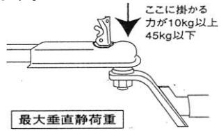
最近の衝撃吸収ボディーや燃費向上を図った軽量化のため、特にモノコックボディー車は車側の取付部分が弱く、破損する恐れがあります。
