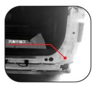
※左写真は車両右側のおおよその穴位置です。 横・下方向から必ず確認しながら印をしてください。 6mm程度のドリルで穴を開け、その後41mm程度のホルソーで穴あけ加工してください。
